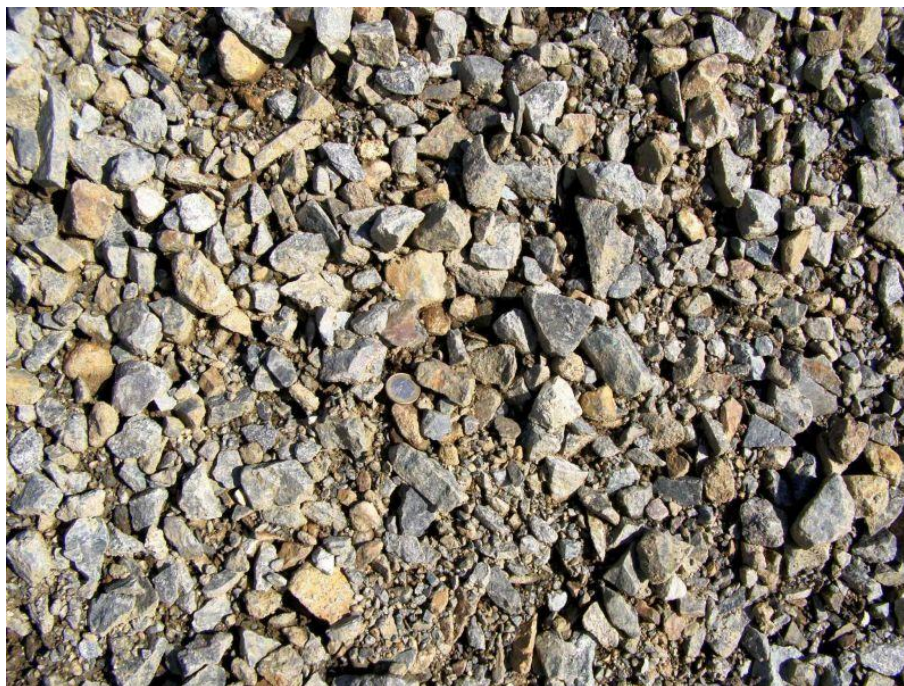
Recyclingmaterial – Schichtstärke ca. 12 – 13 cm – Körnung 0/32 mm
