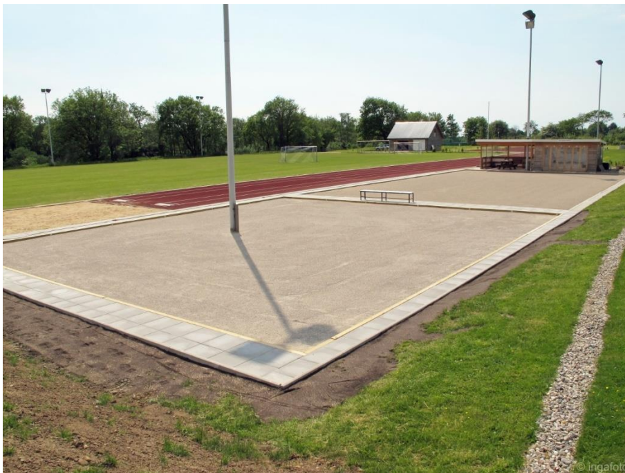
Loser Überwurf - Dicke 0,5 - 1 cm Material Brechsand 0/3 mm
